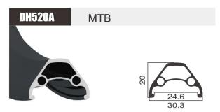
SIZE 26" **JOINT** Pin **FINISH** Pre-Anodizing **MATERIAL** 6061 535g WEIGHT
