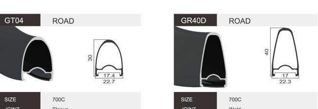
**JOINT JOINT** Weld Sleeve **FINISH** Pre-Anodizing **FINISH** Post-Anodizing MATERIAL 6061 MATERIAL G609 WEIGHT 495g WEIGHT 640g
