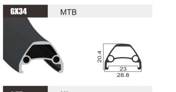
SIZE 29" **JOINT** Pin **FINISH** Pre-Anodizing MATERIAL 6061 WEIGHT 595g
